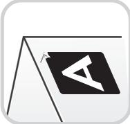
Al finalizar el ajuste, cubra las cajas con las tapas adhesivas / After tightening all the panels, cover the minifix carns with the adhesive caps.
