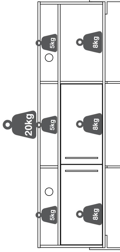
**NOTA:** La resistencia a las cargas puede variar dependiendo si es una carga distribuida o una carga puntual, las gráficas corresponden a cargas puntuales, NO exceder los pesos sugeridos / **NOTE:** The load capacity depends if it is a *point load* or if it is a *uniform distributed load*, do not exceed the *suggested loads*.
